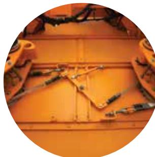
El **nuevo sistema de regulación del freno** de los osciladores permite ajustarlos de forma independiente o ambos al mismo tiempo a través de un mecanismo central.
