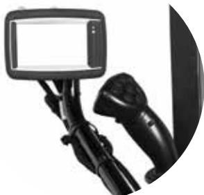
Así, el operador del tractor tiene fácil y rápido acceso a las funciones de encender/apagar y a los ajustes y monitoreos centralizados en este sistema.
