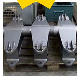
Axle beams for rollercoaster trains Corps d'essieu pour trains de grands huit
