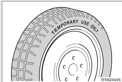
Le pneu de secours compact a été conçu uniquement pour une utilisation provisoire.
