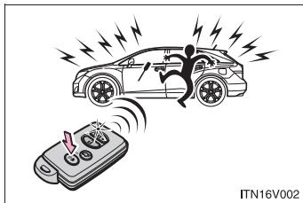
Si l'on appuie sur le bouton (LOUD) pendant un peu plus d'une seconde, une alarme retentira pendant environ 60 secondes et les feux du véhicule clignoteront ou s'allumeront pour dissuader quiconque de tenter d'y pénétrer ou de l'endommager.
