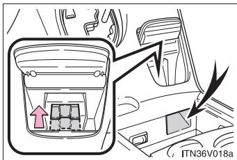
Les compartiments auxiliaires du bloc central avant comportent un trou permettant de passer les câbles allant de la prise de courant à l'adaptateur AUX.
