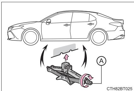
Les repères de point de levage se trouvent sous le bas de caisse. Ils indiquent les positions de point de levage.
