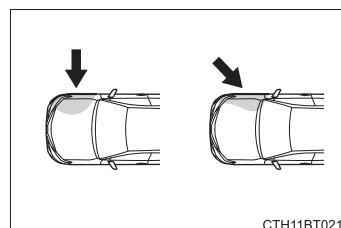
En règle générale, les coussins gonflables latéraux SRS ne se gonflent pas si le véhicule est impliqué dans une collision frontale ou arrière, s'il se retourne ou s'il est impliqué dans une collision latérale à vitesse réduite.
