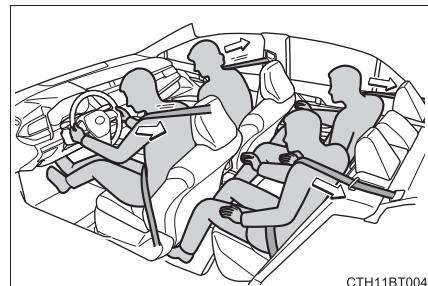
Les prétensionneurs ne se déclenchent pas en cas d'impact frontal mineur, d'impact latéral mineur ou d'impact arrière.
