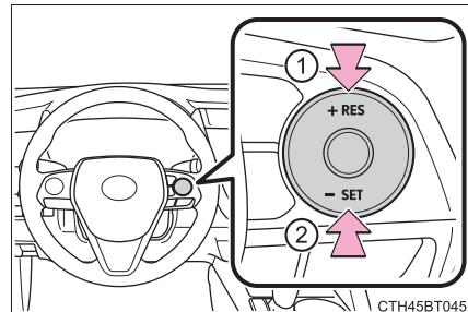
En mode de contrôle de la distance entre véhicules, la vitesse programmée est augmentée ou diminuée comme suit:
