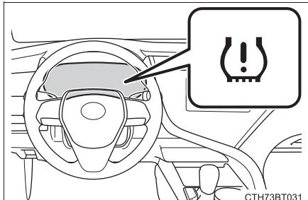
Lorsque l'enregistrement est en cours, le témoin d'avertissement de pression des pneus clignote pendant environ 1 minute puis s'allume et “- -” s'affiche pour la pression de gonflage de chaque pneu sur l'écran multifonctionnel.
