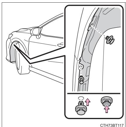
**[9] Pour installer la doublure d'aile sur le pare-chocs avant, insérez le clip dans le pare-chocs avant.**
