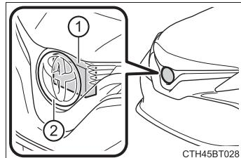
Nettoyez le capteur radar et l'écusson de calandre avec un chiffon doux pour éviter de les rayer ou de les détériorer.
