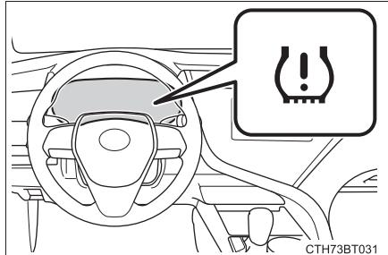
Véhicules avec fonction d'affichage de la pression de gonflage des pneus: “--” s'affiche sur l'écran multifonctionnel pour la pression de gonflage de chaque pneu pendant que l'initialisation est en cours.
