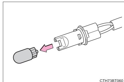
**7** Installez une ampoule neuve puis installez le culot de l'ampoule dans l'éclairage en l'insérant et en le tournant dans le sens des aiguilles d'une montre.
