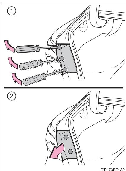
Pour éviter de rayer le véhicule, enveloppez l'extrémité du tournevis plat avec un chiffon, etc.
