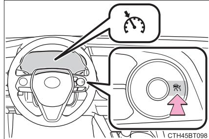
Le passage en mode de régulation de vitesse constante est uniquement possible lorsque la commande est actionnée avec le régulateur de vitesse désactivé.
