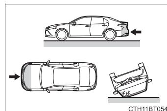
En règle générale, les coussins gonflables rideaux SRS ne se gonflent pas si le véhicule est impliqué dans une collision arrière, s'il se retourne ou s'il est impliqué dans une collision latérale à vitesse réduite ou frontale à vitesse réduite.
