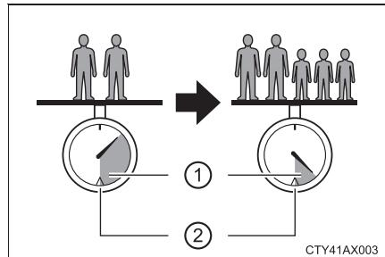
Lorsque 2 personnes avec un poids combiné de A lb. (kg) se trouvent dans le véhicule, dont la capacité de charge totale (capacité de charge du véhicule) est de B lb. (kg), la capacité de charge disponible pour le chargement et les bagages est de C lb. (kg) comme suit:
