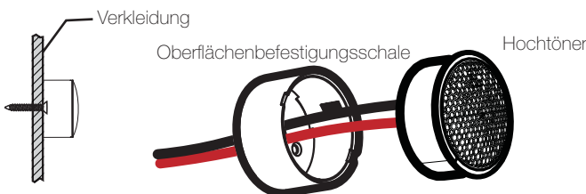
Abb. 4 Einbau auf der Oberfläche
