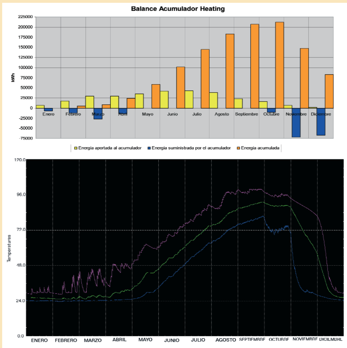
Figura 14. Balance energético del acumulador estacional y evolución de la temperatura a diferentes alturas
