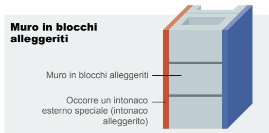
Nel caso di un muro in blocchi alleggeriti, dove non sono stati perfettamente colmati i giunti verticali, è possibile che si verifichino alterazioni dimensionali del supporto. Occorrono intonaci speciali in grado di assecondare i movimenti della parete (intonaci leggeri, intonaci armati...).
