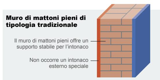
Muro di mattoni pieni di tipologia "tradizionale". Il supporto per l'intonaco è soggetto alle tensioni provocate dai giunti di malta.
