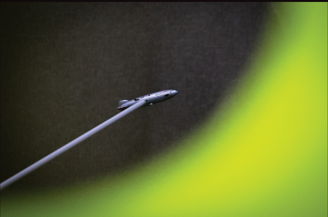
Kalibratiemodel: R33 Airship model Herkomst: National Physics Laboratory (UK) Ontstaan: 1916-21
