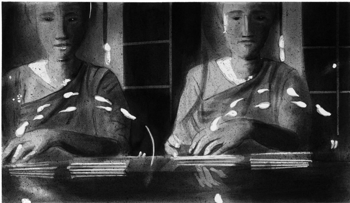
FIG. 4 Een vrouw in een cyclograafstudie toont handbewegingen met het light tracking-systeem. De eerste foto toont puntige vlekken, waarbij de vlekken de richting aangeven. Frank B. Gilbreth (1914)
