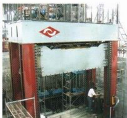
YZL27-1000吨框架式 液压机生产现场:
