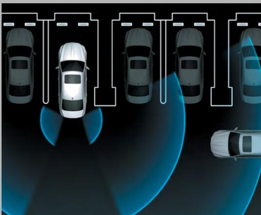
**ALERTE DE CIRCULATION TRANSVERSALE ARRIÈRE** En marche arrière, le dispositif d'alerte de circulation transversale arrière<sup>17</sup> utilise un radar à ondes quasi-millimétriques pour aider à détecter les véhicules qui s'approchent de la zone située derrière la LS et aviser le conducteur par des alertes audio et des indicateurs dans les rétroviseurs.
