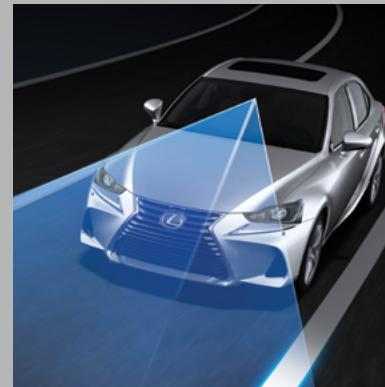
**SYSTÈME D'ALERTE DE SORTIE DE VOIE<sup>12</sup>** Alors que vos yeux fixent la route, un système de caméra fait de même et détecte les lignes tracées sur la route, et vous alerte lorsque le véhicule sort de sa voie.
