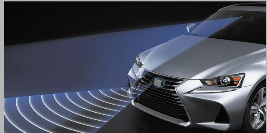
**RÉGULATEUR DE VITESSE DYNAMIQUE À RADAR<sup>8</sup> ET SYSTÈME PRÉCOLLISION<sup>9</sup>** Un système avancé de régulateur de vitesse maintient une vitesse constante et ajuste la vitesse du véhicule en fonction de la circulation. De plus, un capteur radar à ondes millimétriques détecte les véhicules et les obstacles devant vous, évalue la distance à laquelle ils se trouvent, détermine s'il y a risque de collision et aide le véhicule à l'éviter, le cas échéant.
