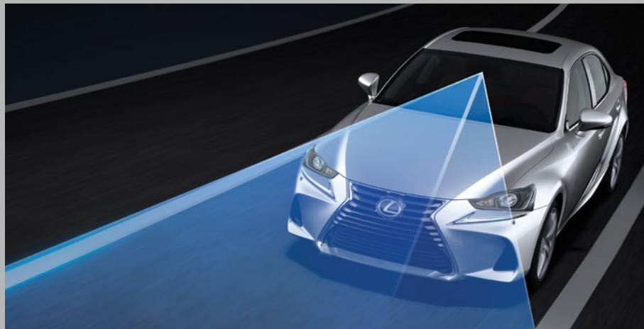
**SYSTÈME D'ALERTE DE SORTIE DE VOIE<sup>4</sup>** Alors que vos yeux fixent la route, un système de caméra fait de même et détecte les lignes tracées sur la route, et vous alerte lorsque le véhicule sort de sa voie.
