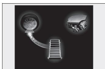
Le flux d'énergie est signalé par le mouvement des flèches sur l'écran multifonction.
