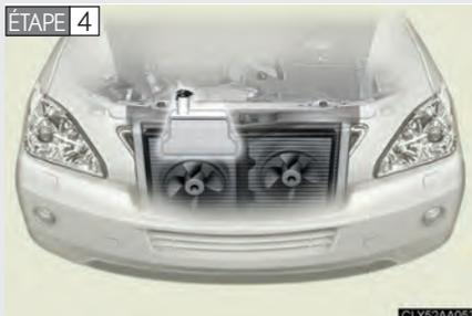
Après que le système hybride ait suffisamment refroidi, vérifiez le niveau de liquide de refroidissement et recherchez une fuite au niveau du radiateur.
