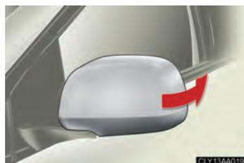
Poussez dans la direction de l'arrière du véhicule.
