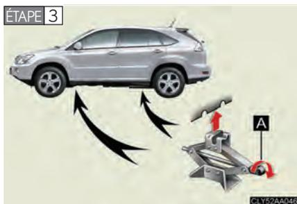
Tournez la partie "A" du cric à la main jusqu'à en amener l'encoche au contact du point de levage du bas de caisse.
