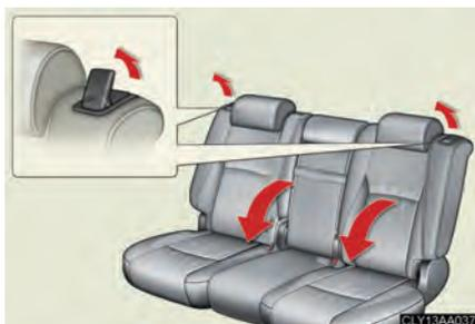
Tirez sur le levier d'inclinaison de dossier de siège et rabattez les dossiers vers l'avant, jusqu'au verrouillage.
