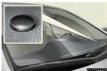
Le capteur risque de ne pas fonctionner normalement s'il est recouvert par un objet, ou masqué par un élément fixé au pare-brise. Dans ce cas, le capteur ne peut plus détecter l'intensité de la lumière ambiante et risque d'entraîner un mauvais fonctionnement du système d'allumage automatique des projecteurs.
