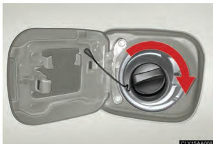
Pour remettre en place le bouchon du réservoir de carburant, tournez-le jusqu'à ce que vous perceviez un déclic.
