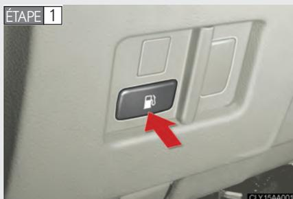
Appuyez sur le bouton d'ouverture de la trappe à carburant.
