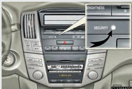
Fermez les portes et le capot et verrouillez toutes les portes avec une clé ou la télécommande du verrouillage centralisé. Le système est automatiquement activé après 30 secondes.
