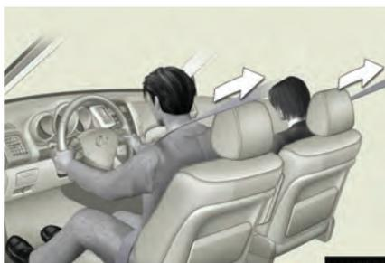
Le prétensionneur agit sur la ceinture de sécurité pour plaquer très rapidement le passager contre son siège, en la rétractant lorsque le véhicule subit un choc frontal violent (dans des cas précis), ou fait un tonneau.
