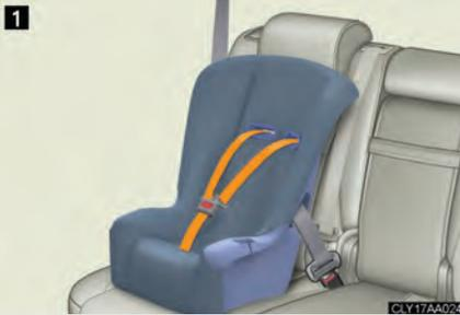
**1** Ceintures de sécurité équipées d'un mécanisme de verrouillage pour sièges de sécurité enfant (ceintures ALR/ELR, sauf celle du conducteur) (→P.63)
