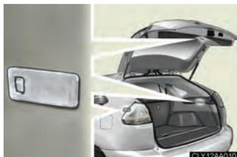
L'éclairage de coffre s'allume lorsque le hayon est ouvert, à condition que l'interrupteur d'éclairage soit sur "ON" (MARCHE).
