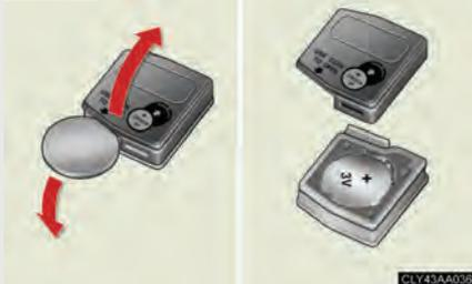
Ouvrez le couvercle du logement de la pile et retirez la pile usée.
