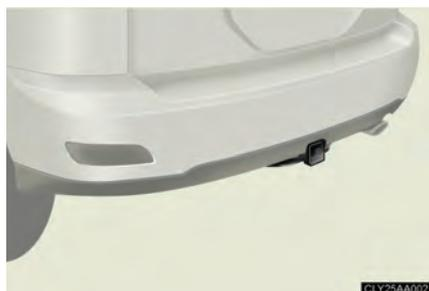
La capacité de traction nominale du coupleur de crochet d'attelage monté sous le pare-chocs arrière est prévue pour ne pas excéder la capacité de traction totale du véhicule.
