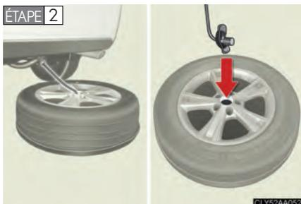
Placez la roue crevée sur le cache de roue de secours, face extérieure vers le haut, et installez le berceau.
