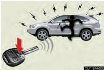
Si vous appuyez sur la touche "PANIC" pendant plus d'1 seconde, une alarme retentit pendant 30 secondes environ et les feux du véhicule clignotent afin de dissuader quiconque de pénétrer à bord du véhicule par effraction, ou bien de lui causer des dommages.
