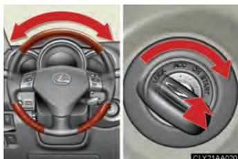
Au démarrage du système hybride, le contacteur de démarrage peut paraître bloqué en position "LOCK" (VERROUILLAGE). Pour le débloquer, tournez en même temps la clé dans le contact et tournez légèrement le volant à droite ou à gauche.
