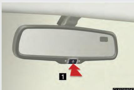
1 Pour sélectionner/désélectionner le mode automatique, appuyez sur le bouton pendant plus de 3 secondes.
