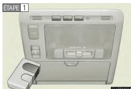
Pointez la télécommande du système à piloter, à une distance comprise entre 1 et 3 in. (25 et 75 mm), en direction des touches de commande HomeLink®.
