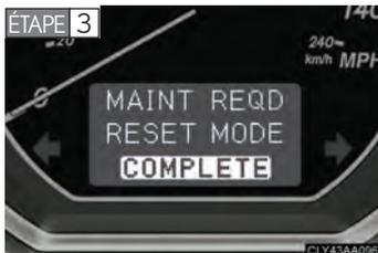
Appuyez sur le bouton "ODO/TRIP" et, sans le relâcher, mettez le contacteur de démarrage sur "ON" (MARCHÉ). Le message "MAINT REQD RESET MODE" s'affiche à l'écran. Pour sélectionner le système, appuyez sur le bouton pendant plus de 5 secondes. Le message "COMPLETE" s'affiche et le système confirme par un bip.
