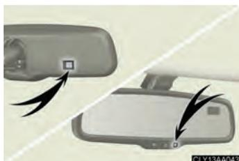
Afin d'assurer un fonctionnement correct des capteurs, évitez de les toucher du doigt et de les recouvrir.
