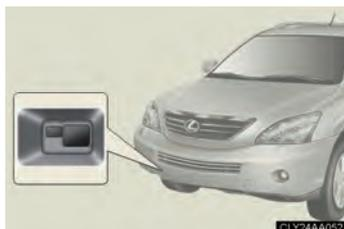
Le capteur doit toujours être en excellent état de propreté, pour garantir le fonctionnement normal du mode de contrôle de la distance entre véhicules. (Certains obstacles, tels que la neige, la glace ou les objets en plastique, ne sont pas détectables par le capteur d'obstruction.)
