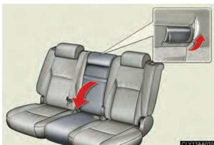
Tirez sur le levier d'inclinaison du dossier de siège central et rabattez ce dernier vers l'avant.
