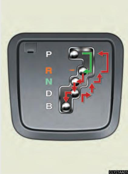
➔ Contacteur de démarrage sur "ON" (MARCHE), appuyez sur la pédale de frein et manœuvrez le levier de sélecteur.
