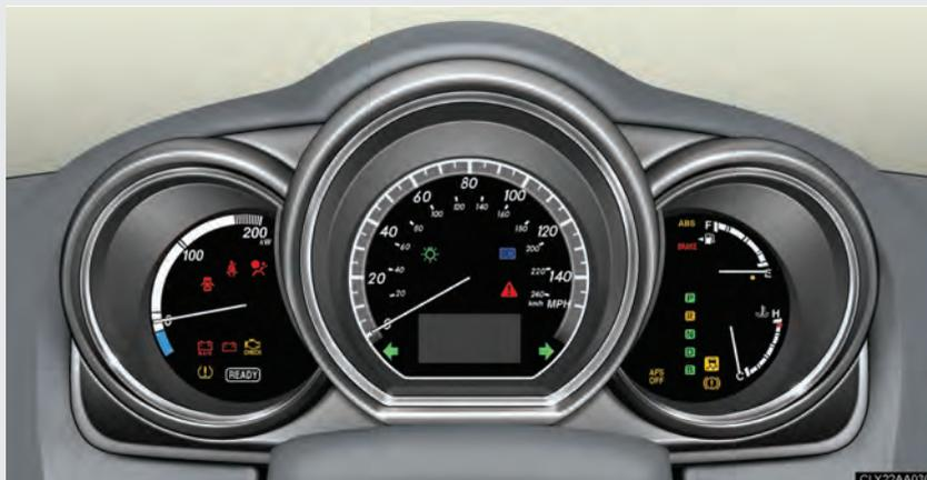
Les unités figurant sur le compteur de vitesse et sur l'indicateur de puissance instantanée ne sont pas les mêmes selon le modèle/type.
