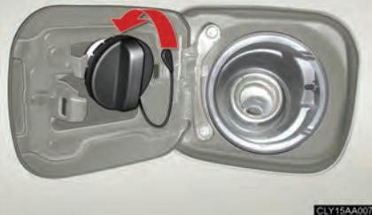
Accrochez le bouchon au dos de la trappe à carburant.
