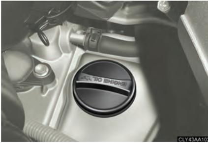
Si le niveau d'huile est sous le repère mini ou à peine au-dessus, faites l'appoint avec une huile de même type que celle utilisée dans le moteur.
