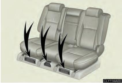
Des prises d'air de ventilation sont situées sous le siège arrière pour permettre le refroidissement de la batterie du système hybride. Si ces prises d'air sont bouchées, la batterie du système hybride risque de surchauffer, avec pour conséquence une baisse de puissance.
