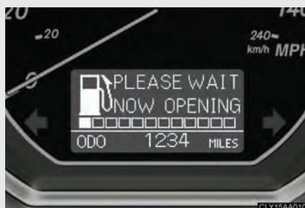
Si le réservoir de carburant est sous pression à cet instant, le message "PLEASE WAIT NOW OPENING" s'affiche à l'écran multifonctionnel. Cela peut prendre jusqu'à 10 secondes.
