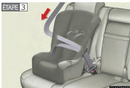
Déroulez complètement la sangle diagonale, puis laissez-la s'enrouler de quelques millimètres afin d'armer l'enrouleur à verrouillage automatique.
