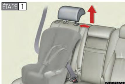
Fixez le siège de sécurité enfant avec la ceinture de sécurité ou à un point d'ancrage inférieur, puis démontez l'appui-tête.
