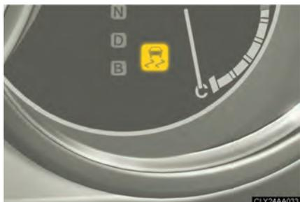
Dans les cas où le véhicule est en situation d'adhérence précaire, ou les roues avant (sur modèles à 2 roues motrices) ou toutes les roues (sur modèles 4 roues motrices) patinent, le témoin de patinage s'allume pour signaler au conducteur l'intervention des systèmes antipatinage/VSC.
