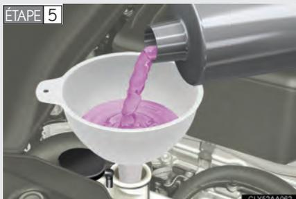
Faites au besoin l'appoint en liquide de refroidissement moteur.
