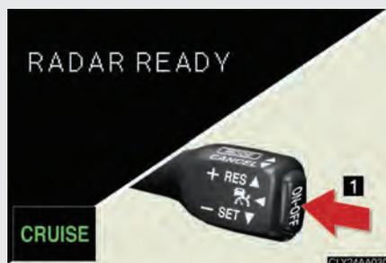
Sélection du mode de contrôle de la distance entre véhicules
