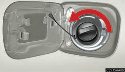
Tournez lentement le bouchon du réservoir de carburant pour l'ouvrir.
