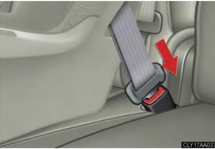
Appuyez sur le bouton de déverrouillage de la boucle et enroulez complètement la ceinture de sécurité.
