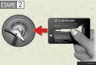
Approchez le support de clé du contacteur de démarrage dans un délai de 10 secondes, en l'orientant comme indiqué par la flèche.
