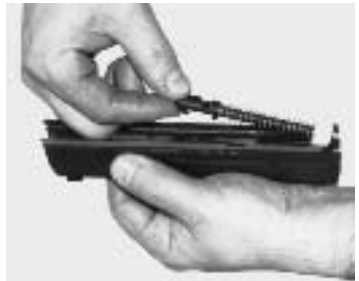
Schließfeder, vollst. entnehmen
