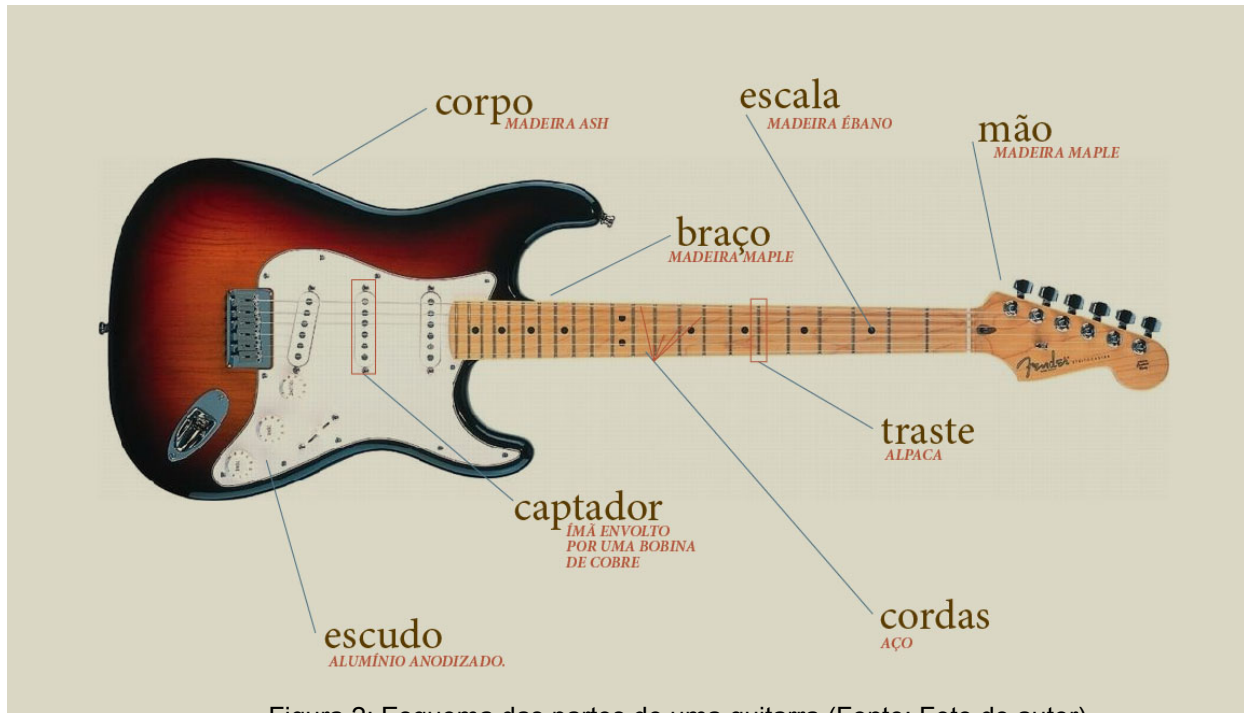
Figura 2: Esquema das partes de uma guitarra (Fonte: Foto do autor)
